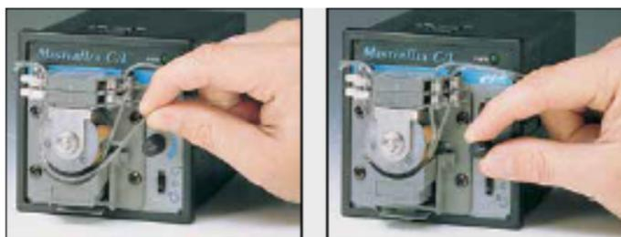
1. Опустите трек головки. Оберните трубку вокруг роликов и закрепите трубки в держателе.
