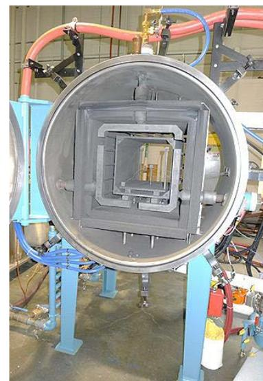
равномерное распределение температуры по всему объему печи. Жесткая графитовая изоляция обеспечивает долгий срок службы зоны нагрева даже при наличии легколетучих связующих компонентов в обрабатываемом материале. Разработанная и запатентованная компанией Centorr/Vacuum Industries система подачи газа Sweergas® позволяет очень быстро очищать зону нагрева и камеру от продуктов сгорания, которые возникают в процессе спекания.
